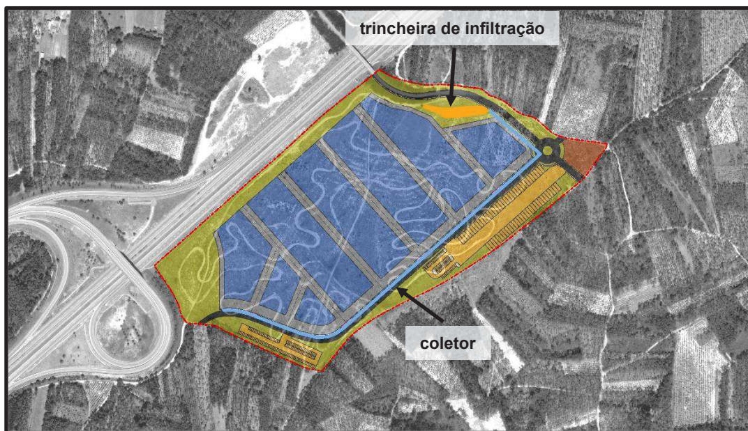
Figura 14 – Enquadramento do traçado esquemático da rede de águas pluviais
