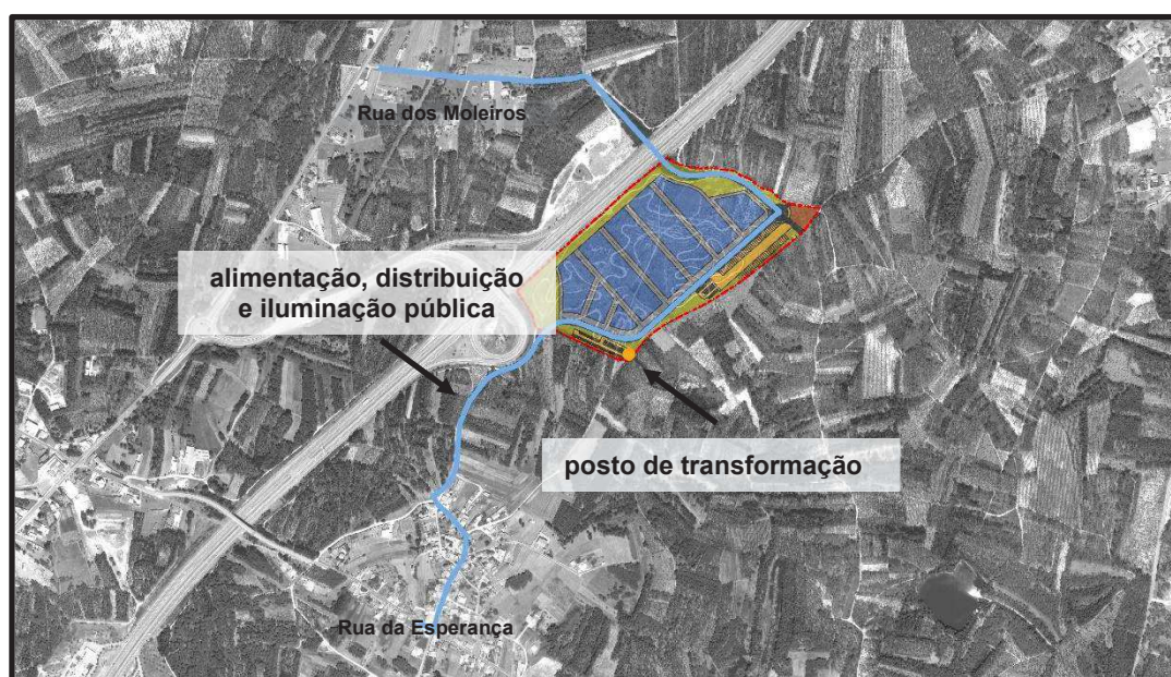
Figura 16 – Enquadramento do traçado esquemático da rede elétrica
